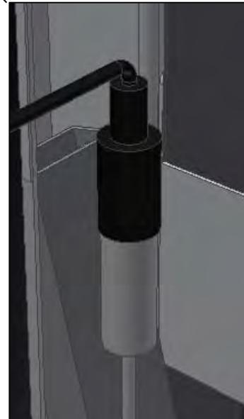
3: Conectar el cable del interruptor de control al cable en espiral
